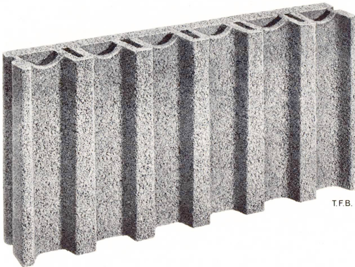
Abb. 1 Sickerplatte mit Doppelkammern und mit Aussparungen für den Überlauf von den äussern in die inneren Kanäle.
