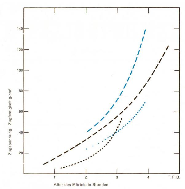
Abb. 1 Entwicklung der Zugfestigkeit (blau) und der Zugspannung infolge Frühschwindens (schwarz) in einem steifplastischen und einem weichplastischen Mörtel (nach Ravina und Shalon).
