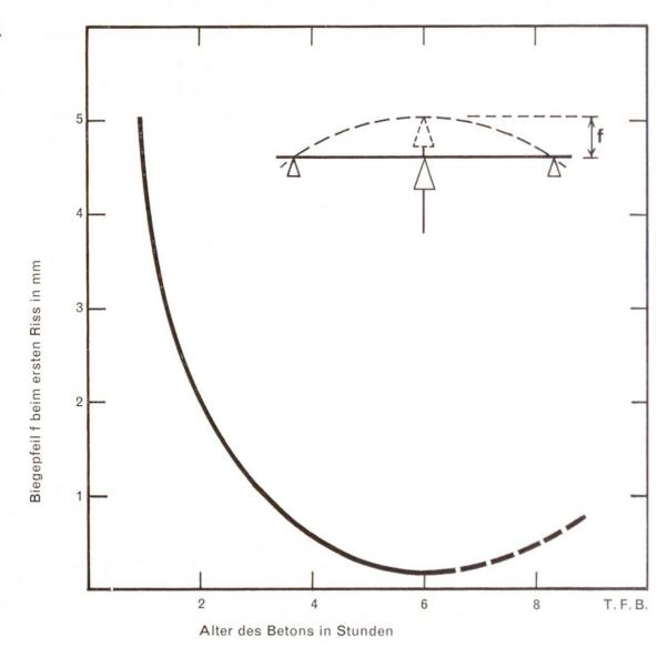
Abb. 2 Abhängigkeit der Bruchverformung vom Alter eines Betons (nach Wierig). Beton 0-30 mm, 270 kg PC/m³, Wasserzementwert 0,66.
