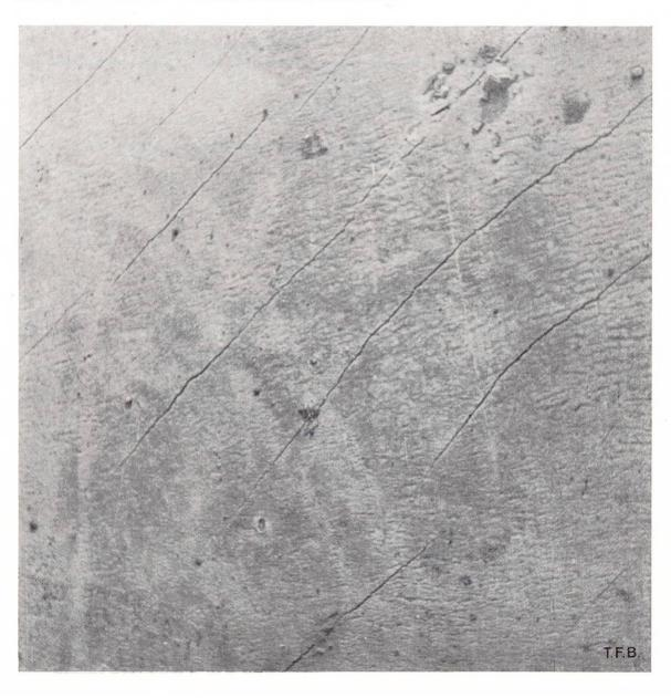
6 gegenüber. Die Spannungen, die aus der Temperaturdifferenz entstehen, wirken im gleichen Sinne wie diejenigen, welche durch das Frühschwinden erzeugt werden. Eine niedrige Lufttemperatur unterstützt den Effekt.
