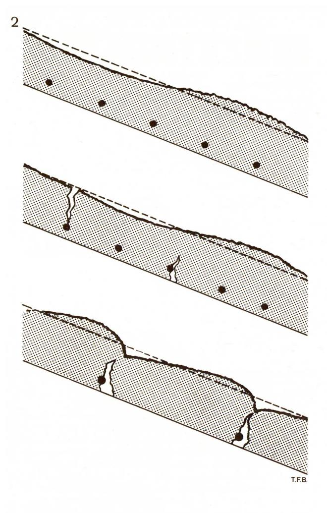
Abb. 1 Fliessen und Gleiten des frisch eingebrachten Betons, Formveränderungen und Rissebildungen.
