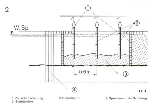
Abb. 4 Schematische Darstellung des Kontraktor-Verfahrens.
