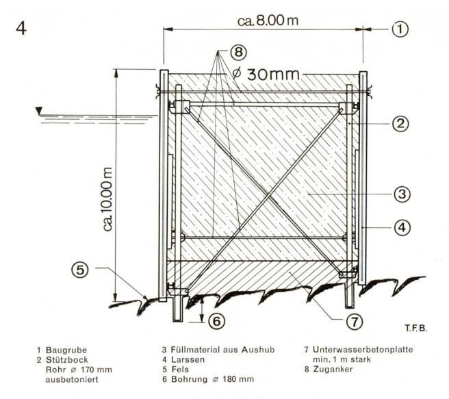
Abb. 2 Fangdamm der Maschinenhaus-Baugrube des Kraftwerkes Säckingen.
