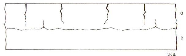
Abb. 2 Rissebildung infolge unterschiedlichem Schwinden von jüngerem (a) und älterem Beton (b).
