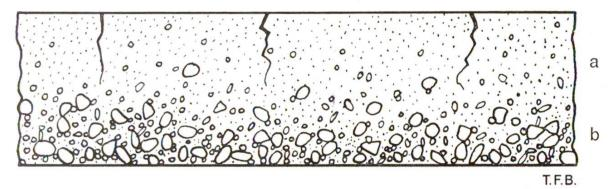
Abb. 3 Rissebildung infolge unterschiedlichem Schwinden von fettem (a) und magerem Beton (b). Die Ungleichmässigkeit entsteht bei zu langem Vibrieren eines flüssigen Betons. Entmischung durch Absetzen (Sedimentation) der gröberen Zuschlagskörner und entsprechende Anreicherung der feineren Bestandteile in der oberen Hälfte.
