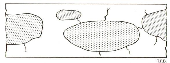
Abb. 5 Interne Risse infolge Schwindzwängung im Bereich grösserer Zuschlagskörner. Wenn keine Risse entstehen, so sind Zugspannungen vorhanden, die gegebenenfalls das Resultat der Festigkeitsprüfung verfälschen, d. h. herabsetzen können (z. B.: Nach 28 Tagen misst man gelegentlich eine kleinere Druckfestigkeit als bereits nach 7 Tagen festgestellt worden war).
