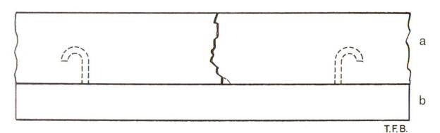
Abb. 4 Schwindrisse bei der Kombination von Beton (a) mit Stahlteilen (b). Bei solcher Bauweise ist der Beton im Hinblick auf kleines Schwindmass und hohe Zugfestigkeit besonders zusammenzusetzen: Wenig Feinstanteile, minimale Zementdosierung, kleinstmöglicher Wasserzementwert und z. T gebrochenes Zuschlagsmaterial. Dies ergibt grundsätzlich einen sehr schwer zu verarbeitenden Beton. Die optimale Zusammensetzung steht keineswegs fest und wird von Fall zu Fall nicht leicht zu finden sein.
