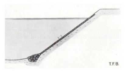
Abb. 2 Ausführung mit Colcrete-Beton: grösstenteils fugenlos, keine aufwendigen Vorarbeiten an der Böschung, geringer Aufwand beim Injizieren unter Wasser.
