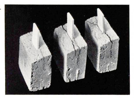
Abb. 6 Risse in Versuchsmörtelprismen, hervorgerufen durch die Sprengwirkung von Korrosionsprodukten an eingebetteten Aluminiumplättchen (nach A. Bukowiecki²).
