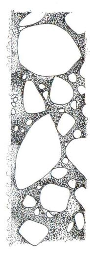
Abb. 2 Interne Entmischung des Zementleims (Wasseranreicherung) ergibt Unterschiede in der Porosität und der Kalkausscheidung an der Oberfläche (halbschematisch).
