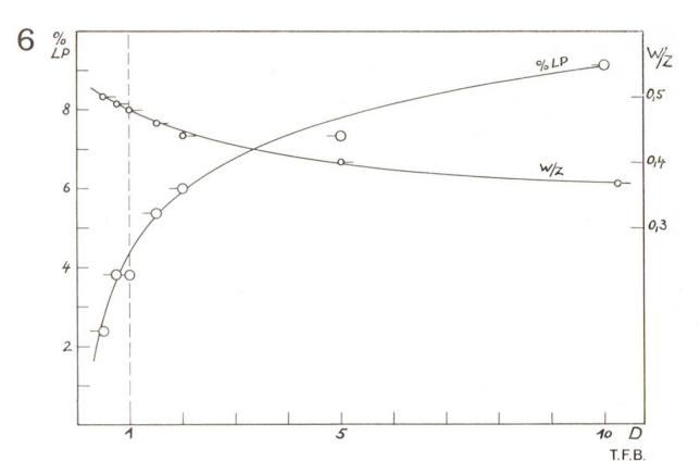
Abb. 3 Einfluss der Dosierung eines LP-Zusatzes auf den Luftporengehalt und den Wasserzementwert bei gleichbleibender Konsistenz. LP-% = Luftporengehalt in Vol.-%, W/Z = Wasserzementwert, D = Dosierung des LP-Zusatzes (1 = vorgeschriebene Dosierung, 10 = zehnfache Dosierung) (nach Hess).
