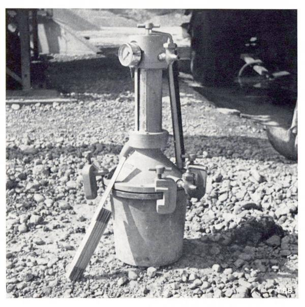
Abb. 1 Gerät zur Messung des Luftporengehaltes im Frischbeton. In das Druckgefäss wird ein bestimmtes Volumen Beton eingefüllt und mit Wasser überdeckt. Wenn nun mittels einer Handluftpumpe der Inhalt unter Druck gesetzt wird, verkleinert sich das Volumen des Betons je nach Luftgehalt mehr oder weniger.
