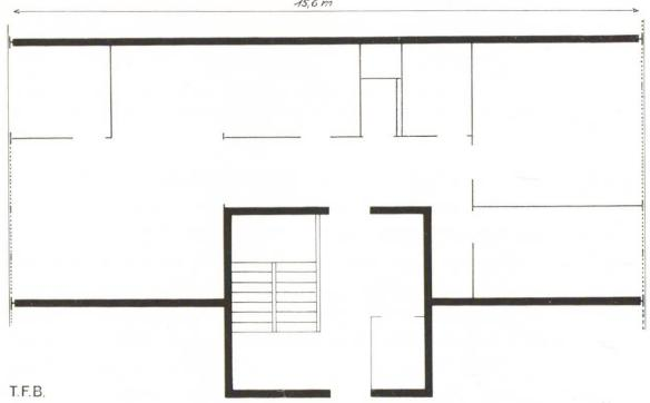
Abb. 2 Schematischer Grundriss einer Normalzelle mit 3-Zimmer-Wohnung. Das Treppenhaus erschliesst zwei Wohnungen pro Stockwerk. Ein solches Wohnungspaar kann in eine 2- und 4-Zimmer-Wohnung verwandelt werden, indem das kleine Schlafzimmer anders zugeteilt wird. Dies bedingt eine Türöffnung durch die Betonwand bei deren Anschluss an das Treppenhaus sowie eine verstärkte Trennwand.
