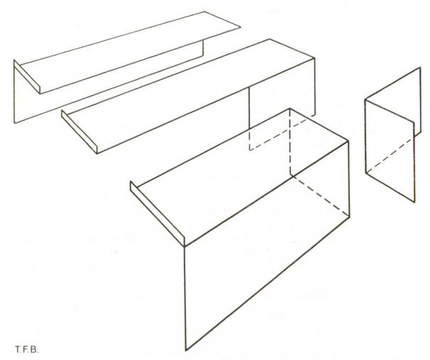
Abb. 3 Schematische Zeichnung der zu Schalungsgerüsten fest zusammengebauten Schalungsflächen für  $\frac{1}{2}$  Wohnzelle und  $\frac{1}{4}$  Treppenhaus (vgl. Abb. 2).
