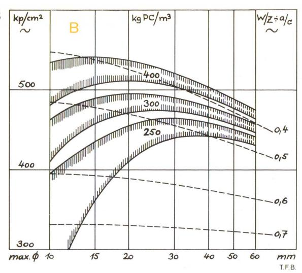
Abb. 2 entsprechend Sieblinientyp B (zwischen Fuller- und EMPA-Kurve)
