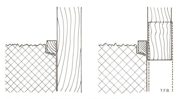
Abb. 11 Verfahren zur Erzielung gerader, scharf zeichnender Arbeitsfugen.
