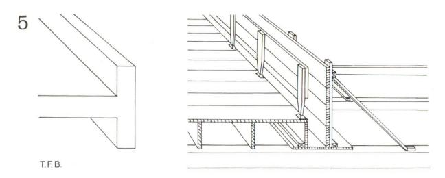
Abb. 13 Schalungsbau bei Brüstungen, die zusammen mit der Decke betoniert werden.
