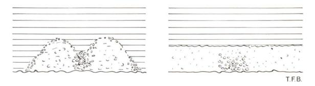
Abb. 15 Bildung von Kiesnestern bei unsachgemässem Einbringen und Verdichten des Betons.
