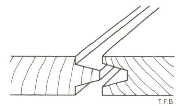
Abb. 1 Schalungsbretter mit speziellem Nut- und Kammpro-fil.
