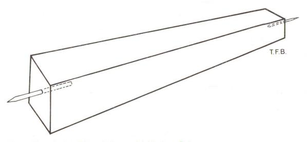
Abb. 9 Vorgefertigte Distanzhalter aus feinkörnigem Beton.
