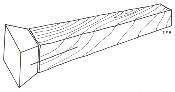
Abb. 8 Distanzhalter mit Betonkopf.
