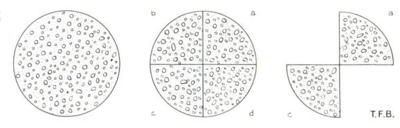
Abb. 2 Um ein körniges Gut (Zuschlag oder Beton) korrekt zu teilen, so dass die beiden Teile in ihrer Zusammensetzung gleichwertig sind, wendet man die Vierteil-Methode an. Das Gut wird auf einer sauberen, harten und fugenlosen Fläche kreisförmig ausgebreitet und entlang zweier, aufeinander senkrecht stehender Linien durch die Mitte in vier ungefähr gleiche Teile geteilt. Je zwei gegenüberliegende Teile (a+e und b+d) werden vereinigt und bilden dann zwei gleichwertige Materialproben.
