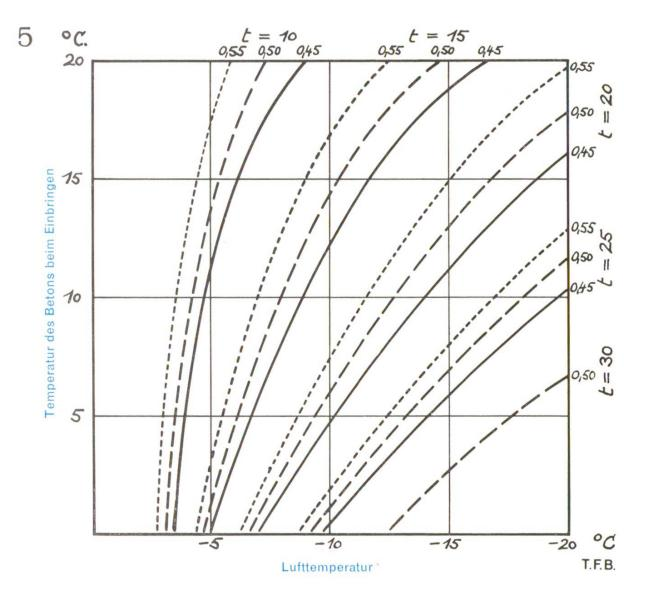
Abb. 3 Mit diesem Diagramm kann die Frage beantwortet werden, ob der Beton bei der Abkühlung vor oder nach Erlangung der kritischen Festigkeit den Gefrierpunkt erreicht. Grundbedingung: Zementdosierung 300 kg/m³, normaler Portlandzement. Parameter: Zeitfaktor t und Wasserzementwert (0,45, 0,50 und 0,55). Man zeichnet den Punkt im Diagramm ein, der sich aus der Temperatur des Betons beim Einbringen und aus der Temperatur der umgebenden Luft ergibt. Kommt dieser Punkt rechts
