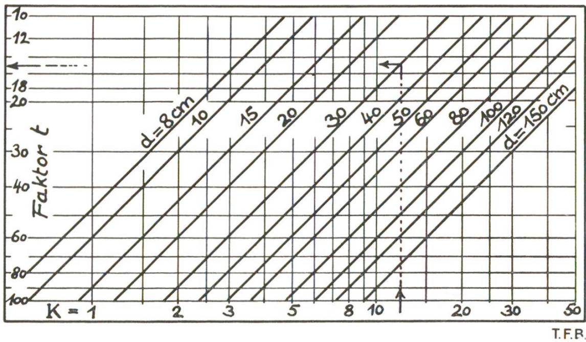
Abb. 2 Diagramm zur Bestimmung des Zeitfaktors  $t$  aus  $K$  und  $d$ . Eingezeichnetes Beispiel:
