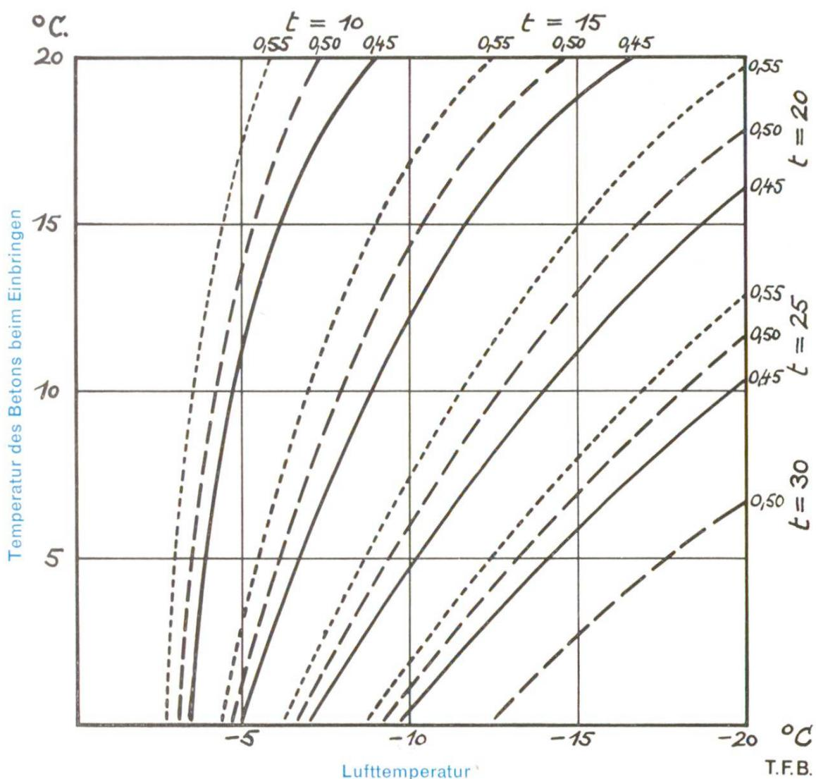
Abb. 3 Mit diesem Diagramm kann die Frage beantwortet werden, ob der Beton bei der Abkühlung vor oder nach Erlangung der kritischen Festigkeit den Gefrierpunkt erreicht.
