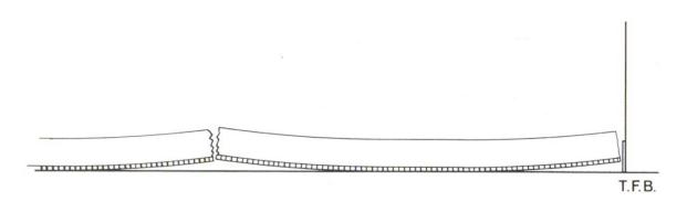
Abb. 5 Zu rasches Austrocknen der Unterlagsböden führt zur Bildung von Schwindrissen. Oft tritt im Bereich der Oberfläche eine stärkere Verkürzung ein, und es entsteht die Tendenz zur Aufwölbung des Belages entlang der Risse und Ränder.
