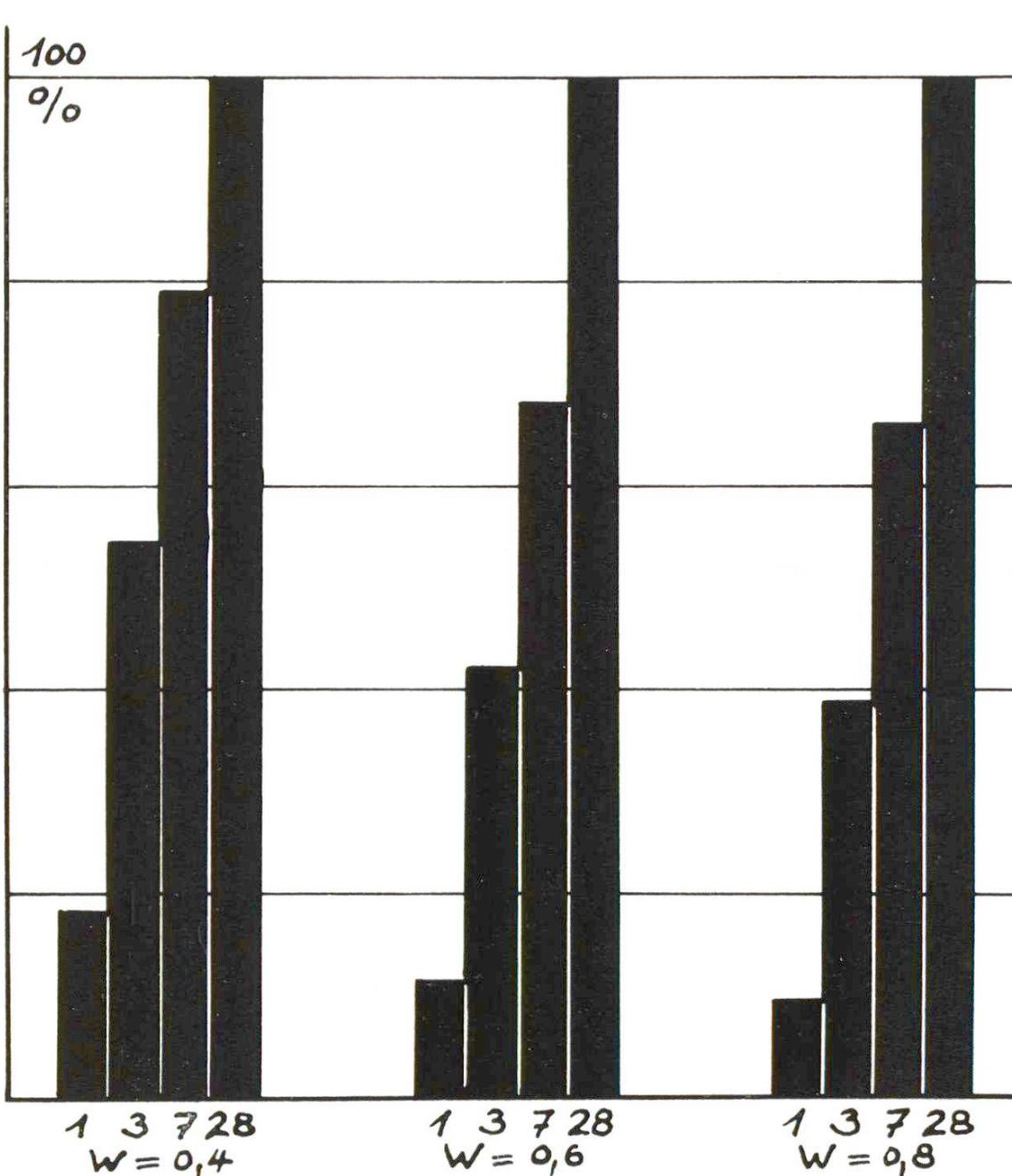
Abb. 2 Die Festigkeiten der Abb. 1, dargestellt in Prozenten der erreichten 28-Tage-Festigkeit.
