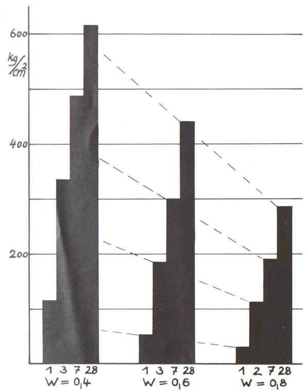
Abb. 1 Würfeldruckfestigkeiten von Betonmischungen mit Wasserzementwerten von 0,4, 0,6 und 0,8 nach 1, 3, 7 und 28 Tagen. Mittelwerte aus Mischungen mit drei verschiedenen Portlandzementen (nach A. Meyer).
