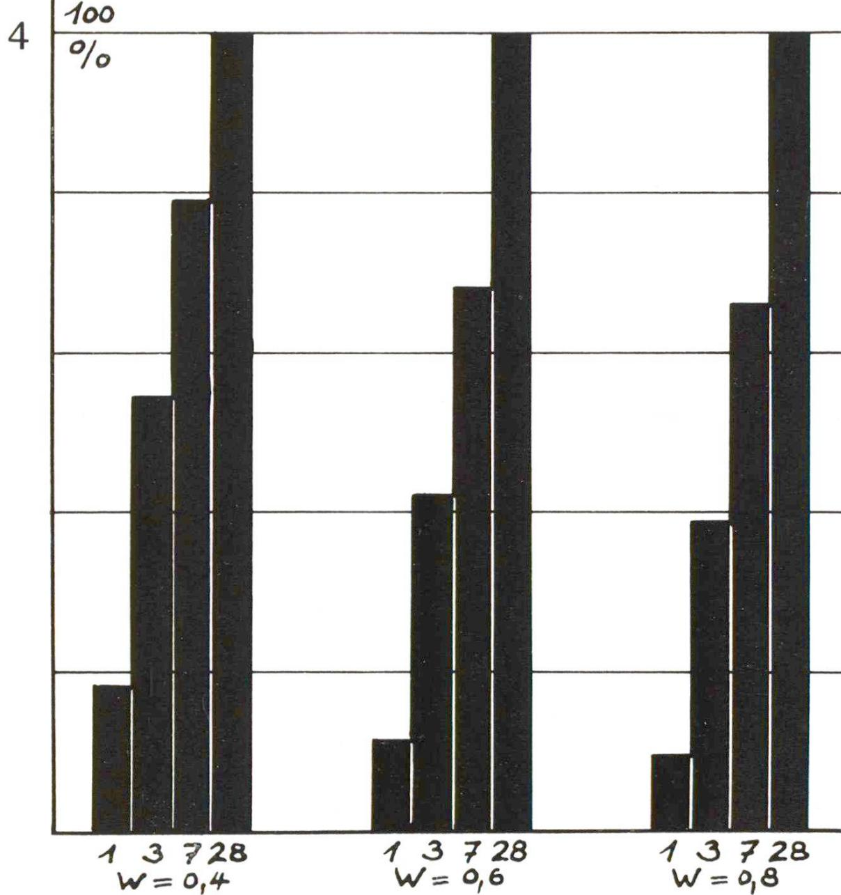
Abb. 2 Die Festigkeiten der Abb. 1, dargestellt in Prozenten der erreichten 28-Tage-Festigkeit.
