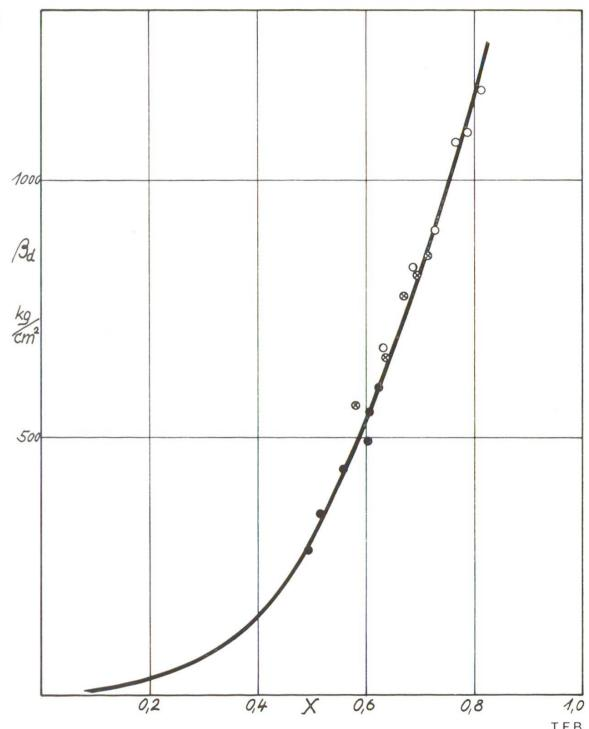
Abb. 4 Abhängigkeit der Würfeldruckfestigkeit ( $\beta_d$ ) vom Anteil des Gelvolumens am verfügbaren Raum (X). Die verschieden gekennzeichneten Punkte beziehen sich auf drei verschiedenartige Mörtelmischungen und zeigen, indem sie alle auf der gleichen Kurve liegen, dass es sich hier um eine grundlegende Beziehung handelt (nach T. C. Powers).
