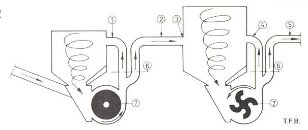
Abb. 1 Schematische Darstellung der Zweitrommel-Mischvorrichtung für kolloidalen Mörtel.
