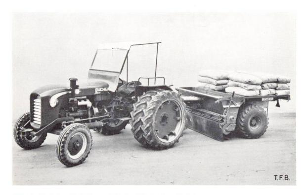
Abb. 2 Verteilgerät für Zement für das Mix-in-place-Verfahren.
