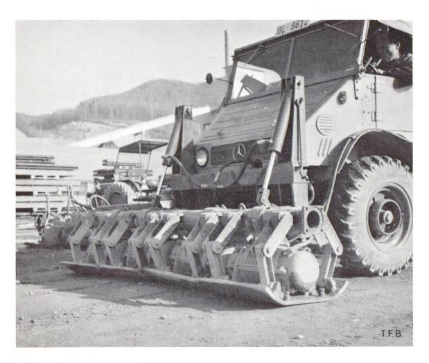
Abb. 4 Mehrplattenvibrator.
