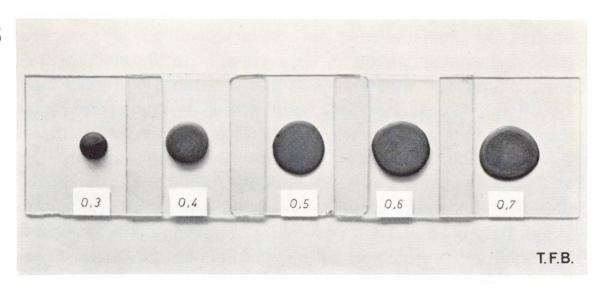
Abb. 1 Einfacher Versuch zum Vergleich des Fliessvermögens von Zementleimen mit verschiedenen Wasserzementwerten. Man erkennt den recht unvermittelten Übergang von der Paste zur Flüssigkeit im Mischungsbereich W/Z=0.4.
