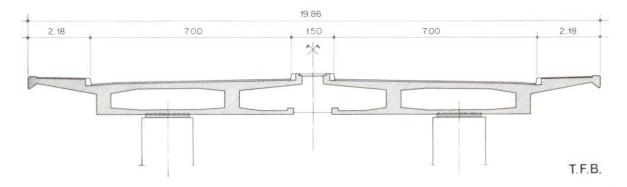
Abb. 2 Normalquerschnitt des Altstetter Viaduktes.
