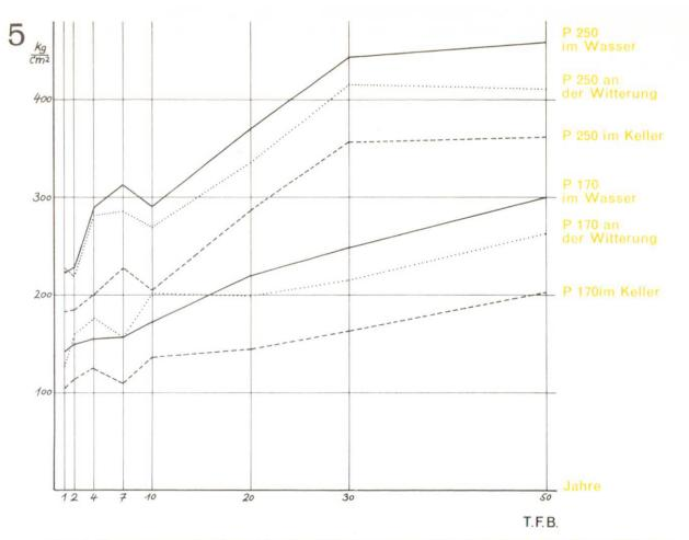
Abb. 1 Entwicklung der Beton-Druckfestigkeit von zwei Betonmischungen unter je drei verschiedenen Lagerungsbedingungen im Zeitraum von 50 Jahren (nach M. O. Withey, s. Literaturangabe).
