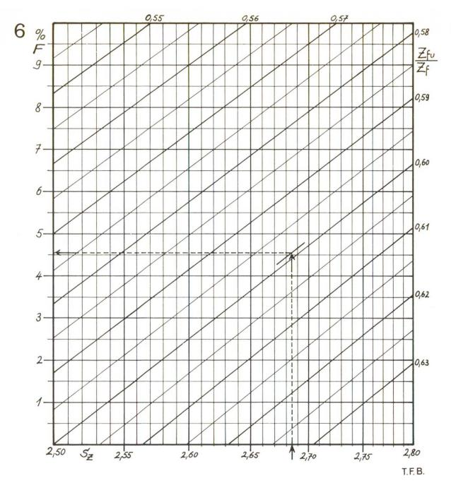
Abb. 2 Diagramm zur Bestimmung des Wassergehaltes von Zuschlagstoffen. Unten das spezifische Gewicht des Zuschlagsgesteins, diagonal das Verhältnis Unterwassergewicht: Probegewicht, links Feuchtigkeit in % (eingezeichnetes Rechnungsbeispiel).
