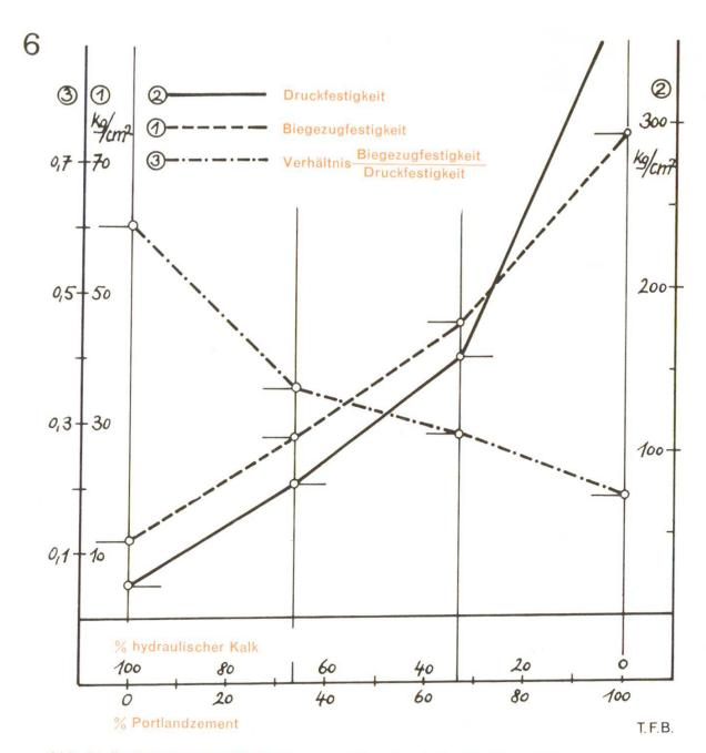
Abb. 3 Festigkeiten nach 28 Tagen von verlängertem hydraulischem Kalkmörtel, gezeigt an Hand eines Versuchsbeispiels über den gesamten möglichen Mischungsbereich. Bindemitteldosierung 400 kg/m³. Eingezeichnet ist auch das Verhältnis Biegezugfestigkeit: Druckfestigkeit, welches mit der Zunahme des HK-Gehaltes ansteigt.
