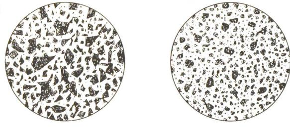
Abb. 1 Mikroskopisches Bild der Körner von Portlandzement (links) und von hydraulischem Kalk (rechts). Vergrösserung etwa 120:1.
