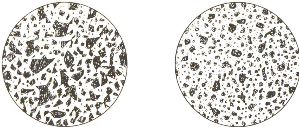
Abb. 1 Mikroskopisches Bild der Körner von Portlandzement (links) und von hydraulischem Kalk (rechts). Vergrößerung etwa 120:1.
