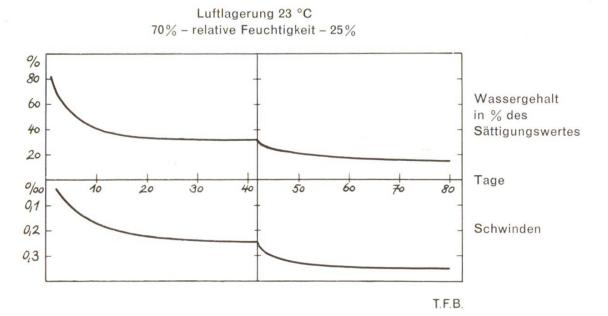
Abb. 2 Austrocknung und Schwinden eines verhältnismässig mageren und porösen Betons. Luftlagerung zunächst bei 70%, dann bei 25% relativer Feuchtigkeit. Man erkennt, dass sich jeweils ein Gleichgewichtszustand zwischen dem Feuchtigkeitsgehalt des Betons und dem der Luft einstellt (nach Kalousek).
