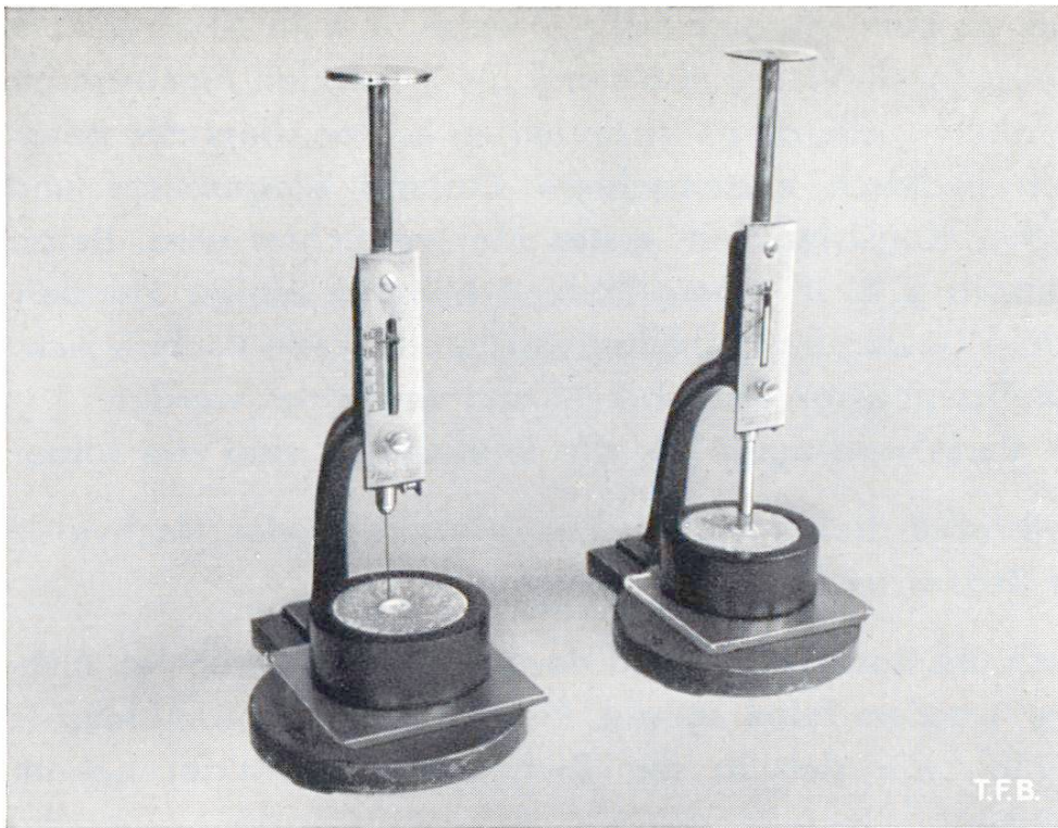
Abb. 2 Vicat-Apparat zur Bestimmung der Abbindezeiten. Rechts: Einrichtung zur Bestimmung der richtigen Konsistenz des Cementbreis. Links: Mit Prüfnadel zur Bestimmung der Eindringtiefen beim Abbindebeginn und Abbindeende
