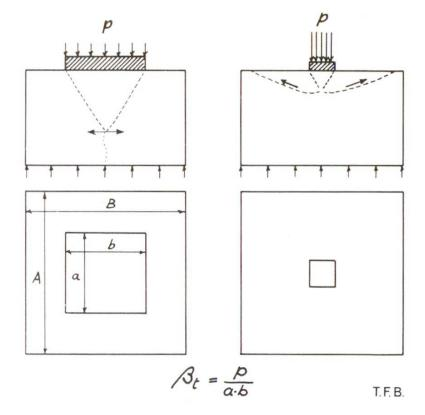
Abb. 5 Schematische Darstellung der Bestimmung der Tragfähigkeit von Beton. Links: Verhältnis Belastungsfläche (a.b) zu Standfläche (A.B) ist relativ gross: Bruch infolge Überbeanspruchung der Zugfestigkeit. Rechts: Bei relativ kleiner Belastungsfläche: Bruch durch Überbeanspruchung der Scherfestigkeit
