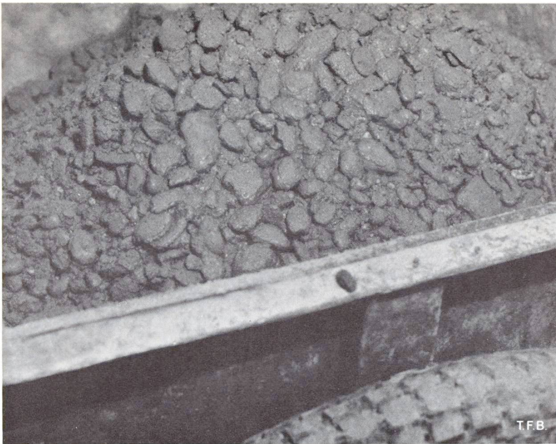
Abb. 2 Leichte Entmischung des Frischbetons bei der Entleerung der Mischmaschine. Hier kann die Entmischungstendenz am besten beurteilt werden
