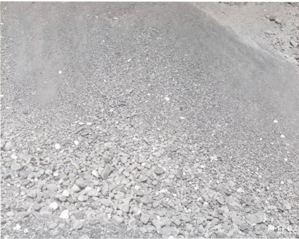
Abb. 1 Entmischung von relativ trockenem Zuschlagsstoff. Wird dieser oft auftretende Effekt nicht beachtet, so entstehen Betonmischungen, die von Fall zu Fall verschiedenen Kornaufbau haben. Die Gefahr der Kiesnesterbildung wird dadurch unter Umständen erhöht
