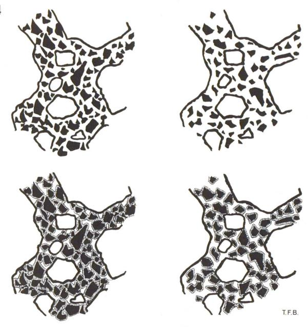
Abb. 3 Bildung von Kapillarporen im Cementleim eines Betons. Oben: frisch angemacht, unten: hydratisiert (erhärtet). Links: Wasser-Cement-Verhältnis ca. 0.5 — durch die Volumenvergrösserung sind die Kapillarporen in sich abgeschlossen worden. Rechts: bei einem Wasser-Cement-Verhältnis von über 0.7 wird trotz derselben Volumenvergrösserung der Festsubstanz keine geschlossene Porosität mehr erreicht.
