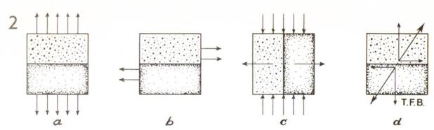
Abb. 1 Einwirkungen verschieden gerichteter Spannungen bezüglich der Haftfläche.
