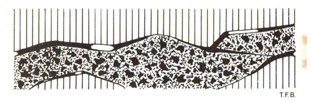
Abb. 5 Haftung vermittelst Kapillarkräften dadurch verursacht, dass sehr feine Spaltflächen mit Wasser oder wässerigen Lösungen ausgefüllt sind.
