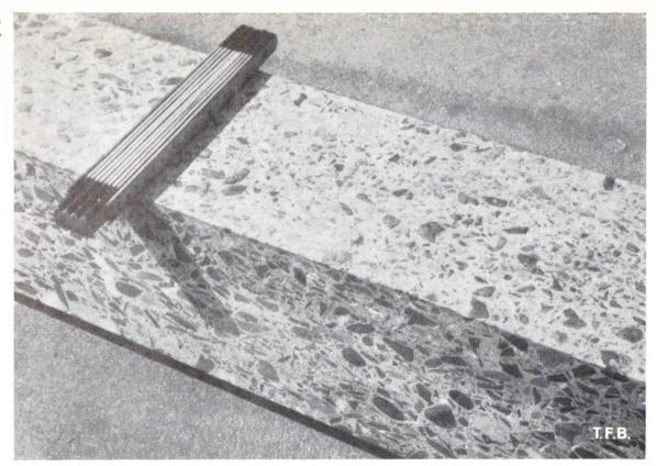
Abb. 1 Ausgesägter Probekörper aus der Betonstrasse Schinznach-Bad — Brugg. 28 Jahre alter Strassenbeton. Trotz der Abnutzung von 2—3 mm zeigt die Oberfläche eine ausgezeichnete Rauhigkeit
