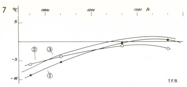
Abb. 6 Ergebnisse von Temperaturmessungen in Strassenoberflächen an einem bedeckten Wintertag (9. Januar 1957). Die Oberflächentemperatur der Betondecke (2) verläuft ausgeglichener als diejenige des bituminösen Belages (1). Die erstere ist mehr von den langfristigen, die andere mehr von den kurzfristigen Witterungsverhältnissen abhängig. (3) = Lufttemperatur
