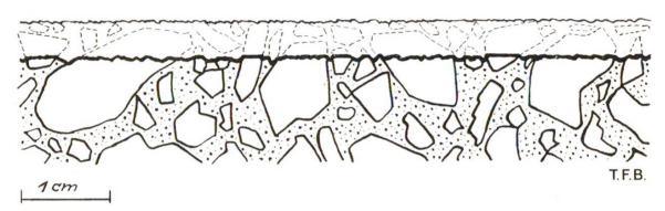
Abb. 2 Auch eine seit Jahrzehnten unter Verkehr liegende Betonstrasse ist immer noch griffig. Dies ist nur bei starrer Einbettung des verschieden harten Zuschlaggesteins möglich
