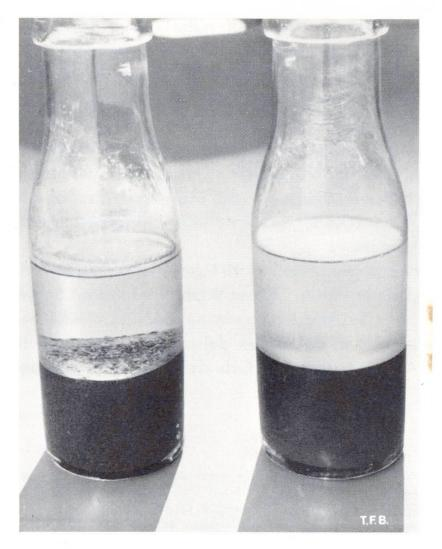
Abb. 5 Bei Verputzarbeiten ist immer auf die Qualität des Sandes, insbesondere auf dessen Sauberkeit zu achten. Hier die einfache Flaschenprobe: Eine kleine Sandmenge wird mit Wasser kräftig durchgeschüttelt. Kurze Zeit darauf ist bei einem gut gewaschenen Sand das überstehende Wasser klar (links), bei unreinem hingegen getrübt (rechts)
