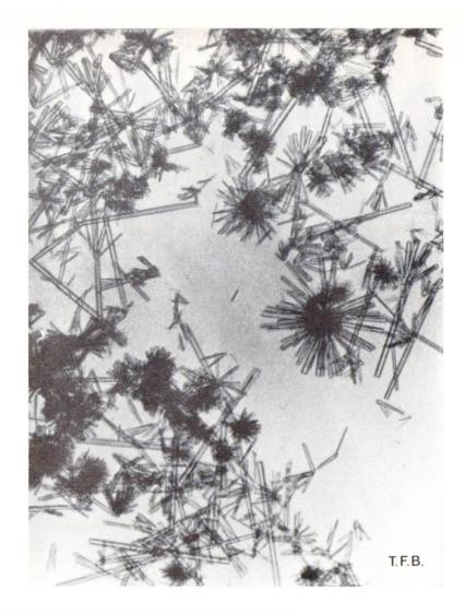
Abb. 1 Ettringitkristalle bei 130facher Vergrösserung (Aufnahme TSH/La)
