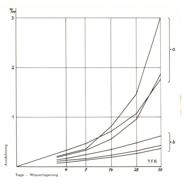
Abb. 5 Versuche der T. F. B. mit denen die Sulfatbeständigkeit an Hand der Ausdehnung von Normenmörtelprismen bei Wasserlagerung kurzfristig bestimmt wurde. Die verwendeten Bindemittel sind vorgängig auf einen einheitlichen  $SO_3$ -Gehalt von  $7^{-0}/_0$  gebracht worden a) Drei verschiedene schweizerische Portlandcemente zeigen vermehrte Ausdehnung durch die Sulfateinwirkung
