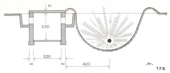
Abb. 2 Sprengversuch in einem Schutzraum aus Beton. Wände 40 cm, unarmiert, aufgelegte armierte Decke. Versuchsanordnung. Sprengung in 4 m Abstand
