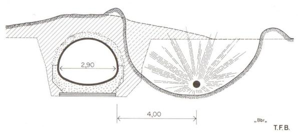
Abb. 4 Sprengversuche an einem vorfabrizierten Schutzraum System Vobag, Wandstärke 7 cm. Versuchsanordnung. Eine zweite Sprengung erfolgte symetrisch auf der anderen Längsseite
