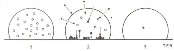
Abb. 1 Kalkausscheidung durch Carbonatisierung (schematisch): In einer bestimmten sehr kleinen Wassermenge sind **21** Moleküle Calciumhydroxyd, Ca(OH)<sub>2</sub>, löslich (¹), hingegen nur 1 Molekül Calciumcarbonat, CaCO<sub>3</sub> (³). Wenn nun aus der Atmosphäre Kohlensäure, CO<sub>2</sub>, in die Lösung eindringt, so verbindet sich diese mit dem Calciumhydroxyd (²). Es entsteht Calciumcarbonat, welches wegen seiner viel geringeren Löslichkeit zwangsläufig ausgeschieden wird
