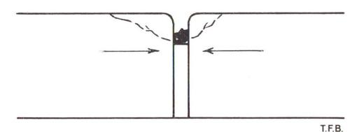
Abb. 4 Aussprengung der Fugenkante bei Verunreinigungen der Fuge, insbesondere durch Mörtelreste
