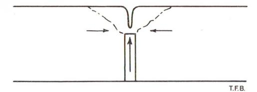
Abb. 3 Aussprengung der Fugenkante bei einer Einlage, welche zu nahe an die Betonoberfläche reicht. Die Zerstörung kann auch durch ein Treiben der Einlage verursacht werden
