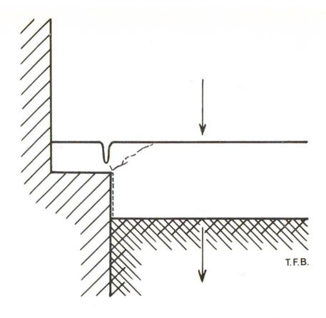
Abb. 2a und b Ungenaue Lage der Fuge eines Betonbelages entlang einer betonierten Mauer. Einseitige Aussprengungen infolge Senkung durch Belastung bzw. Frosthebung. (s. auch Abb. 5)
