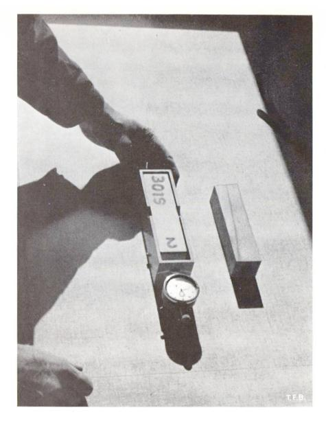
Abb. 4 Schwindmessungen an gewöhnlichen Normenmörtelprismen nach der in der T. F. B. entwickelten vereinfachten Methode
