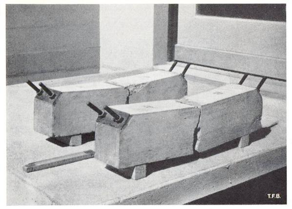
Abb. 2 Versuchskörper aus vorgespanntem Beton, ausgeführt in der T. F. B. 1940
