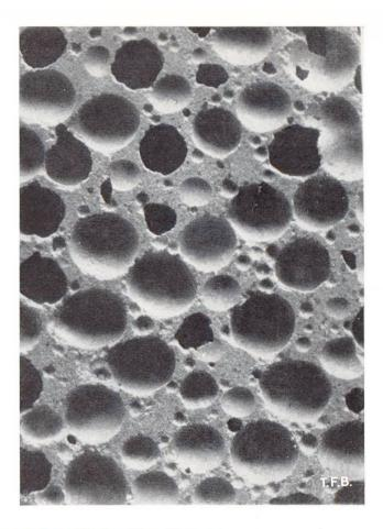
Abb. 2 Strukturbild eines Schaumbetons in zirka 7facher Vergrösserung
