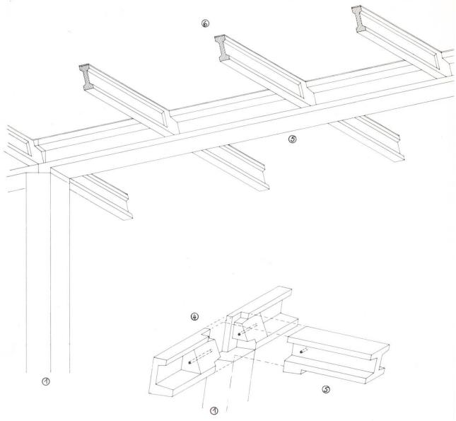
Abb. 4 Schematische Darstellung der Konstruktion. Der U-förmige Untergurt wurde nachträglich mit Links unten:
