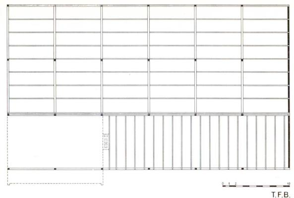
Abb. 2 Draufsicht auf grosses und kleines Pultdach, mit Bindersystem und Pfetten
