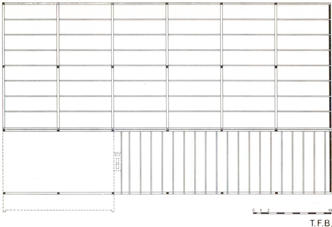
Abb. 2 Draufsicht auf grosses und kleines Pulldach, mit Bindersystem und Pfetten
