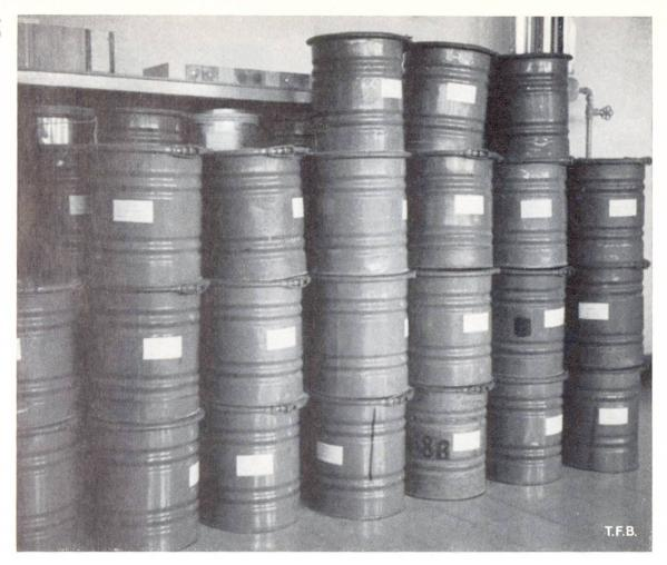
Abb. 4 Gefässe für Cementproben aus Silowagen. Inhalt: 10—15 kg
