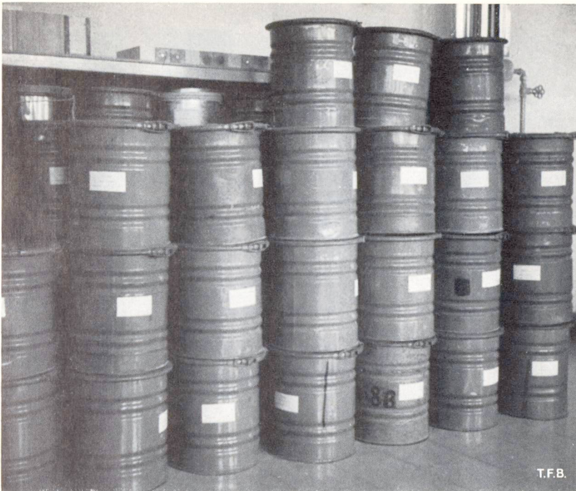
Abb. 4 Gefäße für Cementproben aus Silowagen. Inhalt: 10—15 kg
