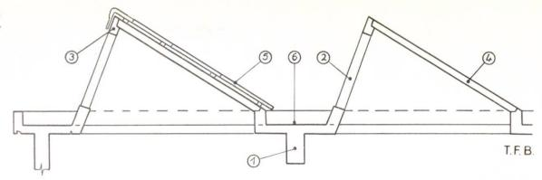
Abb. 1 Querschnitt durch die Shedkonstruktion. 1. Vorgespannter Rinnenträger  $l=21\,$  m. 2. Shedstützen alle 2,05 m. 3. Pfetten,  $l=2,04\,$  m. 4. Leichtbetonplatte. 5. Welleternit. 6. Korkisolation und Kiesklebedach
