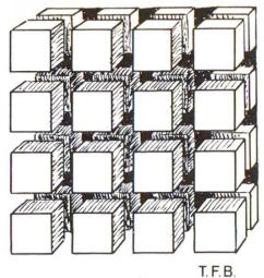
Abb. 4 Auflockerungsgrad von Portlandcement (spezifisches Gewicht = 3,1)
