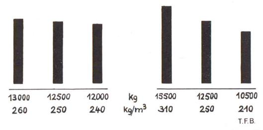
Änderungen im Cementverbrauch infolge der Abmessungsfehler des Zuschlags für 50 m<sup>3</sup> Beton P 250
