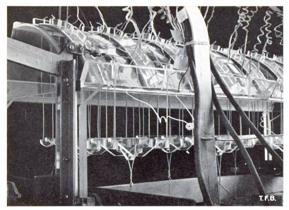
Fig. 3 Anordnung der Dehnungsstreifen. Insgesamt wurden 62 Dehnungsstreifen aufgeklebt
