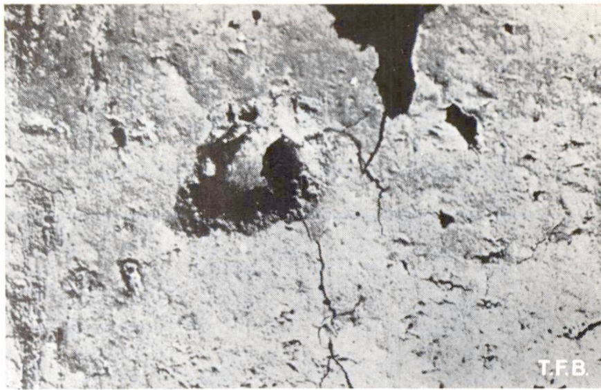
Abb. 1 Schwindrisse und Ablösung als Folge zu fetter Mischung
