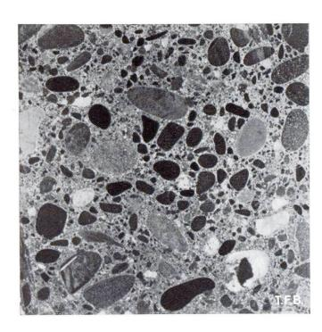
Betonquerschnitt D (polierter Sägeschnitt)
