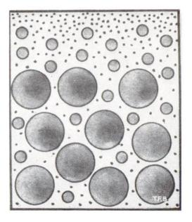
Abb. 2 Schematische Darstellung der Entmischung von plastischem Beton, wie sie durch Erschütterungen eintreten kann. Links: gleichmässige Verteilung; rechts: Aufschlemmung der feinen und Sedimentation der groben Bestandteile
