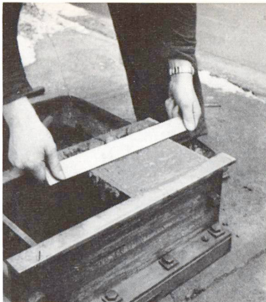
Abb. 10 Sorgfältiges Abstreichen der überstehenden Schicht bei Beginn des Anziehens
