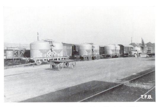
Abb. 1 Umschlagsplatz für Silo-Cement auf dem Hauptbahnhof Zürich. Drei Behälterwagen der SBB zu je  $2 \times 13$  t Portlandcement
