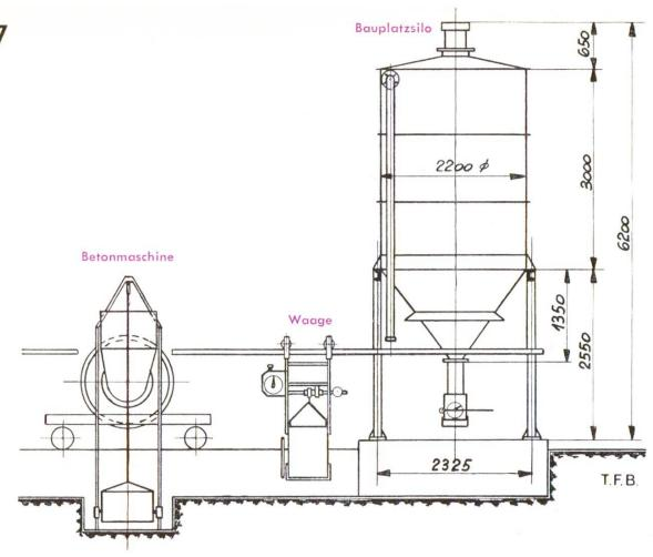
Abb. 8 Bauplatzeinrichtung für Silo-Cement. Inhalt des Cementsilos: 15 t
